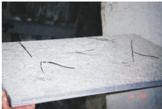
Foto 86 - Utilização de grampos (arame inoxidável), no tardo de placa rochosa, para assentamento em paredes e fachadas.
