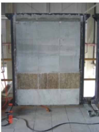
Foto 81 - Resultado do teste da foto 80, observando-se deslocamento das placas assentadas com argamassas cimentícias convencionais.
