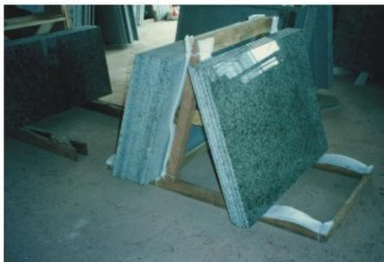
Foto 104 - Placas rochosas armazenadas sobre cavalete de madeira, envolvido por material impermeável (polipropileno expandido).
