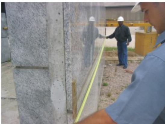
Foto 100 - Avaliação da presença de empenamento em uma peça grande de material granítico.
